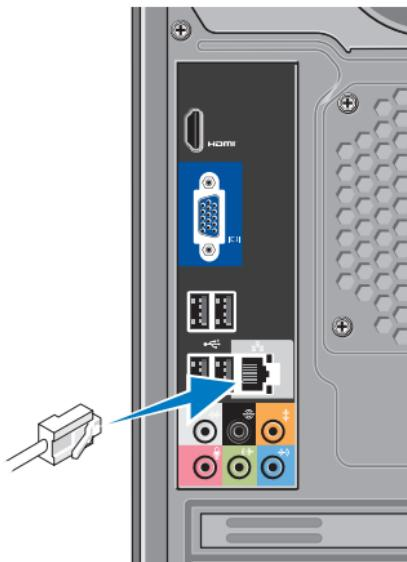
Mrežni priključak nije neophodan za dovršetak postavljanja računala, ali ako imate postojeću mrežnu ili internetsku vezu koja koristi kabelski priključak (poput kućnog kabelskog modema ili ethernet utičnice), sada ga možete priključiti. Koristite samo ethernet kabel (RJ45 priključak). Ne priključujte telefonski kabel (RJ11 priključak) na mrežni priključak.
